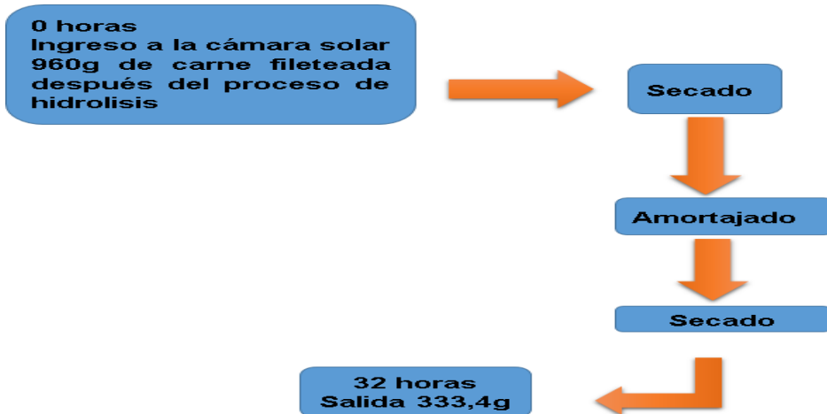
Figura 3. Flujograma de balance másico para la muestra 2 en el deshidratador solar
