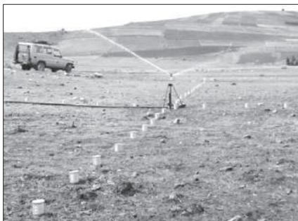
Figura 1. Disposición de pluviómetros y aforo volumétrico del aspersor Xcel Wobbler (E1)
