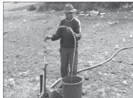
Figura 1. Disposición de pluviómetros y aforo volumétrico del aspersor Xcel Wobbler (E1)
