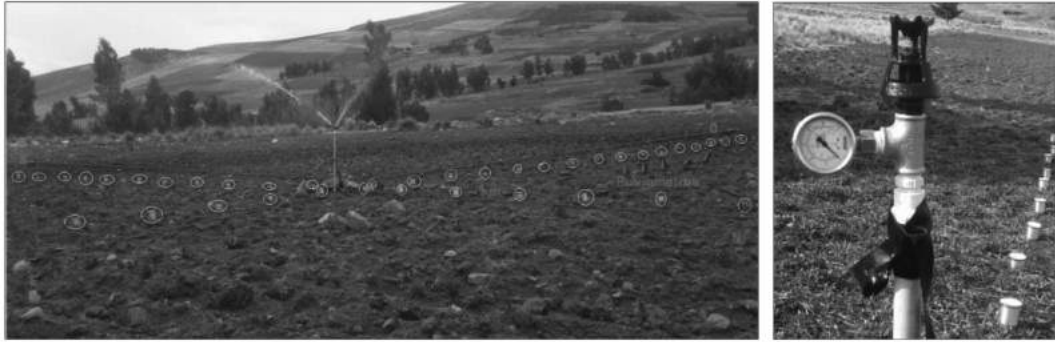
Figura 1. Ubicación de los pluviómetros en torno al equipo móvil de riego
